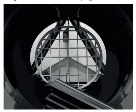
2 | Entfernen Sie eventuell vorhandene Grobstoffe vom Gitterrost und öffnen Sie diesen anschließend mit dem dafür vorgesehenen Seilzug.
