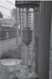
4. Durchfluss am Messgerät ablesen; der Durchfluss nach 10 Minuten Pumpzeit entspricht der Durchlässigkeit der Filterelemente, beträgt der Durchfluss weniger als 6 l/s so müssen die Filterelemente gespült werden
