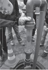
1. Pumpe mit Durchflussmesser, Durchflussregler und Rohrleitung in den Schacht hinablassen
